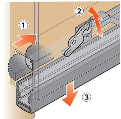
吊元側のトリガーが10mm押し込まれると起動し、ダンパーを効かせながらボトムレールがゆっくり下がる構造です。
